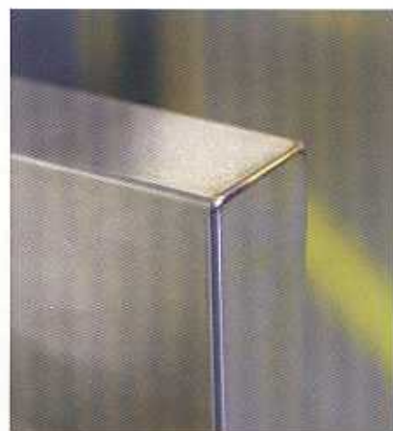
Mit der neuen Schweißroboteranlage gelingen perfekte Schweißnähte, wie hier am Beispiel eines Edelstahl-Gehäuses.
