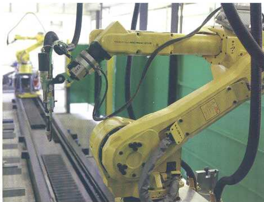
Diese sehr innovative Schweißroboteranlage kann für Kleinserien ab 50 Stk. rationell eingesetzt werden.
